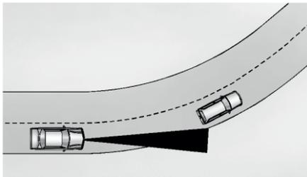
Следуя за автомобилем, при входе в поворот АСС может не обнаружить впереди идущий автомобиль и увеличить скорость до заданного значения. В этом случае индикатор впереди идущего автомобиля пропадает.
