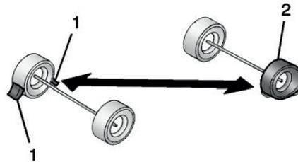
1. Противооткатный упор (в соответствующей комплектации)
