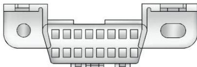
Разъем канала передачи данных расположен под приборной панелью слева от рулевого колеса. Подключение к этой колодке оборудования, не предназначенного для контроля токсичности во время техосмотра или для обслуживания автомобиля, может отразиться на работе автомобиля. См. Дополнительное электрооборудование  $\varnothing$  8-53. За помощью обратитесь к своему дилеру.
