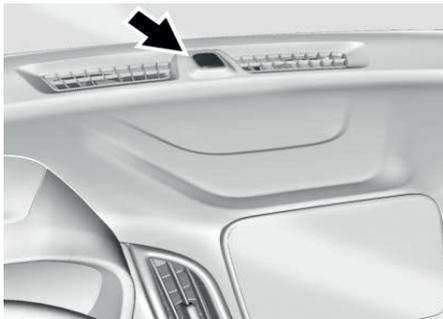
На верхней части панели приборов установлен датчик освещенности. Не накрывайте датчик, в противном случае фары будут включаться даже тогда, когда это не требуется.
