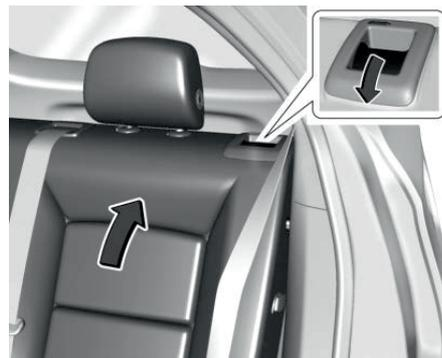
1. Потяните за рычаг регулировки наклона спинки сиденья.
