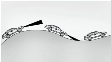
Не используйте АСС при движении на крутых уклонах и при буксировке прицепа. АСС не сможет обнаружить на дороге автомобиль при движении на крутых уклонах. При нажатии педали тормоза адаптивный круиз-контроль отключается.
