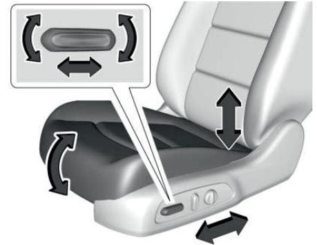
Регулировка положения сиденья с электроприводом (в соответствующей комплектации):
