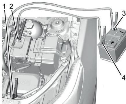
1. Отрицательная клемма (масса) для запуска при разряженной аккумуляторной батарее
