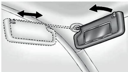
Опустите козырек для защиты глаз от попадания прямого солнечного света. Отсоедините солнцезащитный козырек от центрального шарнирного крепления, чтобы повернуть его к боковому окну или, если предусмотрено комплектацией, выдвинуть вдоль стержня.
