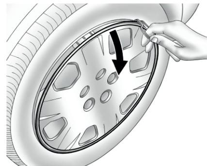
Снимите колесный колпак или центральную крышку, если имеется, чтобы получить доступ к колесным болтам.
