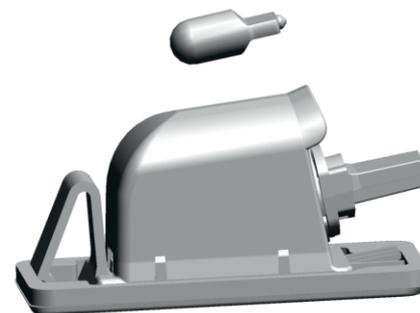
3. Поверните патрон лампы против часовой стрелки, чтобы извлечь его из блок-фары.
