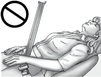
Нельзя наклонять спинку во время движения автомобиля.
