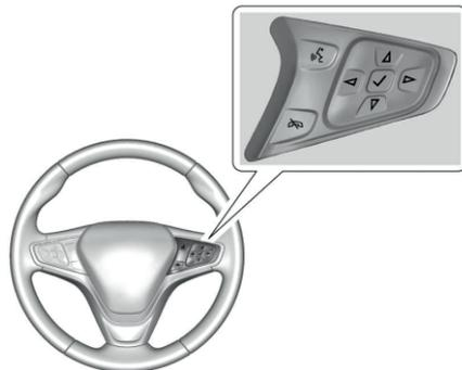
☎ : Если автомобиль оснащен модулем Bluetooth®, нажатие этой клавиши позволяет задействовать его. См. раздел «Bluetooth (Обзор)» ⇨ 6-14; 6-15 или Bluetooth (Органы управления информационно-развлекательной системой) ⇨ 6-14; 6-15» или «Bluetooth (обзор)» в инструкции на информационно-развлекательную систему.
