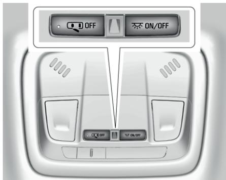
Кнопки управления потолочными плафонами расположены на верхней консоли.
