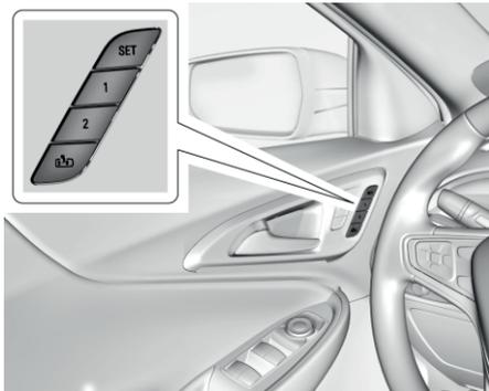
Если сиденья оснащены функцией памяти, два водителя могут сохранить и устанавливать сиденья в индивидуальные положения для вождения, а также в общее положение для выхода из автомобиля. Вы также можете сохранить и другие настройки, например, настройки зеркал и рулевого колеса с электрической регулировкой (если предусмотрено). Сохраненные в памяти положения присоединены к трансмиттеру RKE 1 или 2 и могут автоматически вызываться из памяти.
