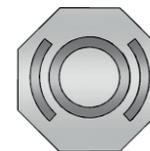
В бачок главного тормозного цилиндра залита сертифицированная GM тормозная жидкость DOT 4, как указано на крышке бачка. См. раздел Общий вид моторного отсека  $\varnothing$  9-5, 9-6, где показано местоположение бачка.
