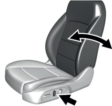
Для регулировки спинки сиденья с электроприводом (если он имеется):
