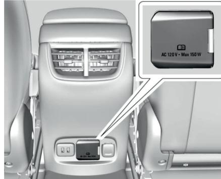
Розетка питания расположена на центральной консоли сзади. Когда к розетке подключен какой-то потребитель, загорается встроенный в нее индикатор. Индикатор загорается, если зажигание включено, к розетке подключен потребитель мощностью не более 150 Вт и отсутствуют какие-либо неисправности системы.
