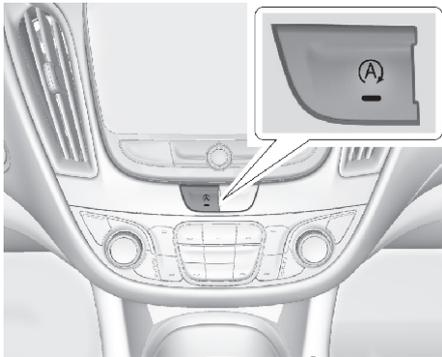
Функция автоматической остановки и пуска двигателя может быть отключена или снова включена нажатием клавиши со значком (A). Функция автоматической остановки и пуска двигателя включается при каждом в ключении зажигания. Если значок (A) горит, значит система включена.
