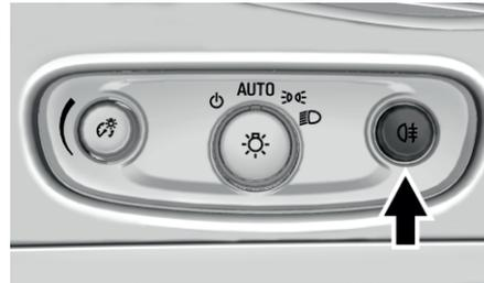
Задние противотуманные фонари улучшают видимость автомобиля сзади в условиях тумана или измороси.
