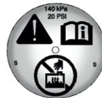
Снимать крышку с предохранительным клапаном с расширительного бачка можно только после остывания системы охлаждения, крышки с предохранительным клапаном расширительного бачка и верхнего шланга радиатора.
