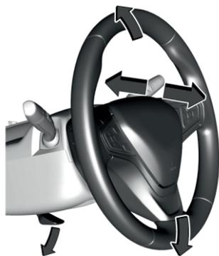
Чтобы выполнить регулировку рулевого колеса:
