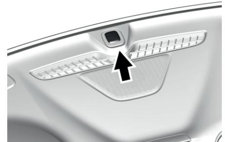
На верхней части панели приборов установлен датчик освещенности. Не накрывайте ничем датчик, иначе фары будут включаться даже тогда, когда этого не требуется.
