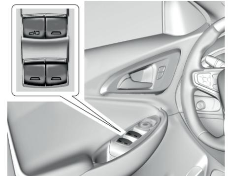
Электропривод оконных стекол работает только тогда, когда автомобиль находится в режиме ON / RUN (ВКЛ) или ACC / ACCESSORY (ВСПОМОГАТЕЛЬНОЕ ОБОРУДОВАНИЕ), а также в режиме задержки отключения питания
