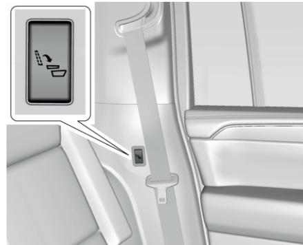
**Переключатель на задней панели со стороны водителя**
