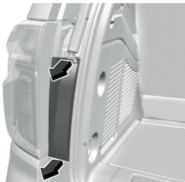
3. Снимите с заднего фонаря нижнюю прилегающую крышку, потянув ее вниз за верхнюю и нижнюю части, чтобы освободить защелки.
