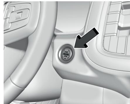
Автомобили, оснащенные системой дистанционной идентификации ключей, запускаются нажатием кнопки.
