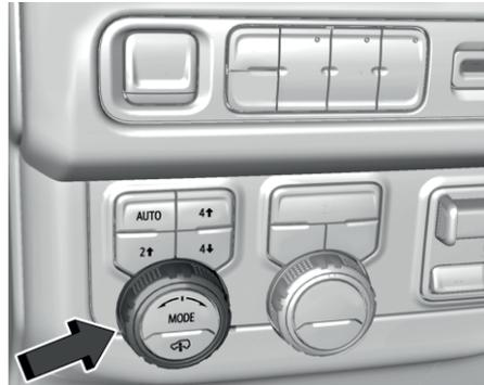
Чтобы перейти в любой из режимов, поверните ручку Mode (режим), расположенную на щитке приборов слева от рулевого колеса.
