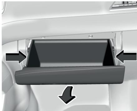
2. Нажмите на боковые стенки перчаточного ящика, высвобождая его из фиксаторов, после чего опустите ящик.
