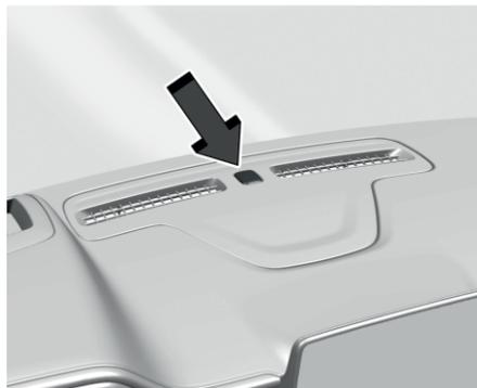
На верхней части панели приборов установлен датчик освещенности. Не накрывайте ничем датчик, иначе фары будут включаться даже тогда, когда этого не требуется.
