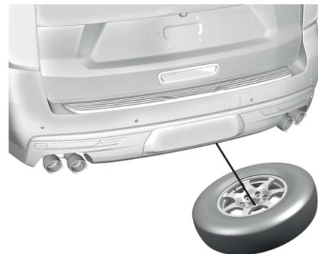
7. Чтобы получить доступ к фиксатору колесного диска, наклоните колесо к автомобилю, слегка ослабив трос.
