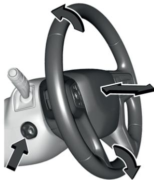
Чтобы отрегулировать рулевое колесо, если возможность регулировки предусмотрена:
