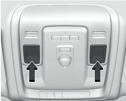
В потолочной консоли и на панели обивки крыши находятся плафоны индивидуального освещения (если предусмотрены комплектацией).
