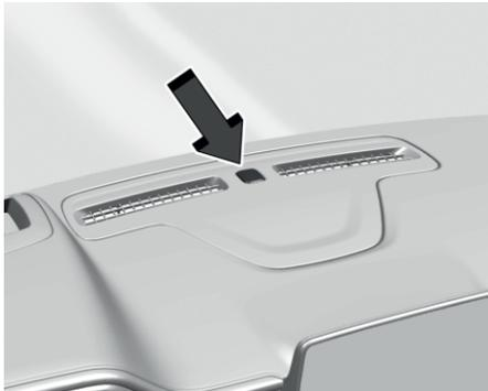
Датчик освещенности на приборной панели рядом с лобовым стеклом контролирует интенсивность солнечного излучения.
