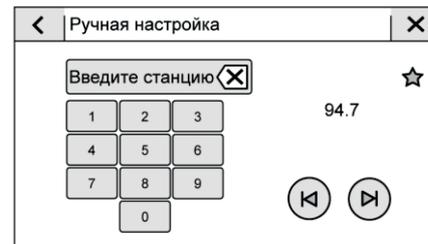
Для прямой настройки на экране AM или FM коснитесь значка Поиск для вызова экранной клавиатуры. Прокручивайте список всех частот вверх и вниз с помощью кнопок или . Введите частоту с помощью названной клавиатуры. При вводе новой станции справа появляется информация об этой станции. Эта информация обновляется с появлением каждой новой доступной для настройки частоты.
