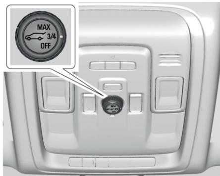
Если автомобиль оснащен прозрачным люком крыши с электроприводом, то переключатель управления люком находится на верхней консоли. Автомобиль должен быть в режиме Р (стоянка).
