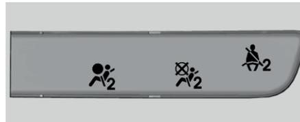
Сиденье переднего пассажира оснащено системой обнаружения присутствия пассажира. При включении зажигания на верхней консоли отображается индикатор
