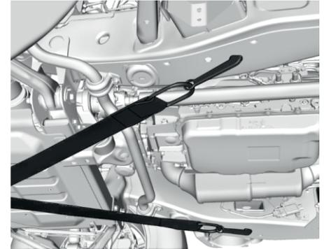
Автомобиль оснащен специальными точками крепления, служащими для его втягивания на плоскую платформу для перевозки легковых автомобилей с ровной поверхности дороги. Не используйте эти точки крепления, чтобы вытянуть автомобиль из снега, грязи и песка.
