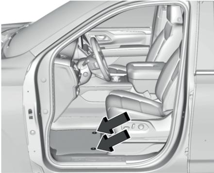
Установите коврик на место. Для этого совместите отверстия напольного коврика, предназначенные для фиксаторов, и фиксаторы коврика, а затем закрепите их. Убедитесь, что напольный коврик надлежащим образом закреплен на месте. Убедитесь, что коврик не препятствует нажатию педалей.
