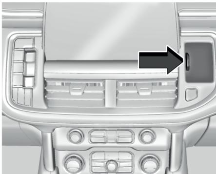
В панели приборов предусмотрено отделение для хранения мелких вещей. Чтобы открыть его, нажмите на кнопку и сдвиньте крышку до фиксации. Чтобы закрыть, нажмите на кнопку и отпустите. Дверца закроется автоматически.
