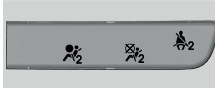
При запуске автомобиля в ходе проверки системы индикатор состояния подушки безопасности пассажира попеременно включает на несколько секунд символы включенной и отключенной подушки.
