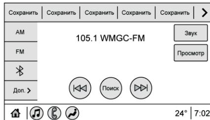
На экране диапазона AM или FM нажмите или на центральной консоли, чтобы выполнить поиск предыдущей или следующей станции с устойчивым сигналом.
