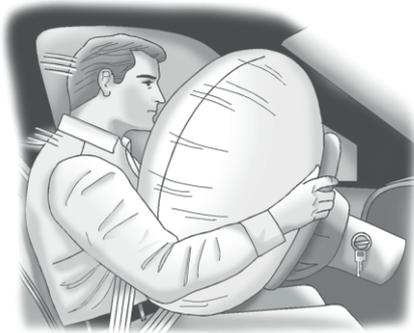
Передняя подушка безопасности на стороне водителя находится в центральной части рулевого колеса.
