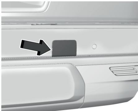
1. Откройте съемную крышку вала подъемника (3) в бампере, чтобы получить доступ к замку запасного колеса (6).
