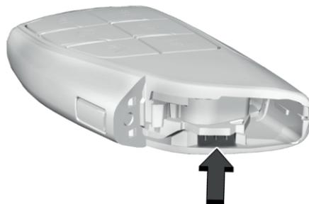
2. Вынув механический ключ, вставьте тонкий плоский предмет в середину радиобрелока и отделите и снимите заднюю крышку.
