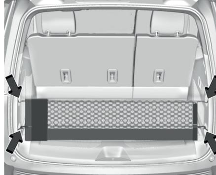
Автомобиль может быть укомплектован багажной сеткой, которая крепится в задней части автомобиля. Прикрепите ее к креплениям для хранения небольших грузов.
