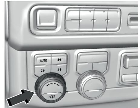
Если автомобиль оснащен раздаточной коробкой, то ее органы управления служат для включения и отключения привода на четыре колеса.
