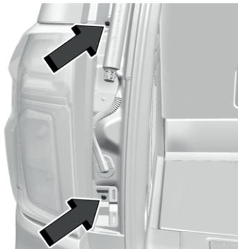
4. Снимите два винта заднего фонаря.
