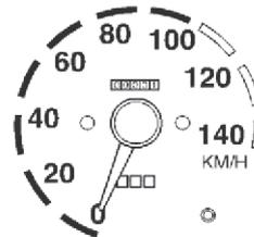
При превышении автомобилем предельной величины скорости звучит предупреждающий сигнал, (только в некоторых моделях)
