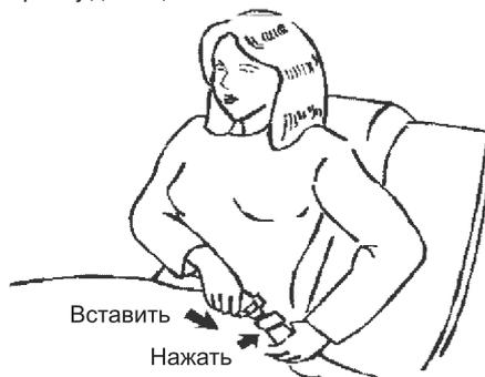
Для увеличения длины удерживайте металлическую пластину защелки под прямым углом к ленте и потяните за ленту. Для уменьшения длины потяните свободный конец ремня в сторону от пластины металлической защелки затем потяните зажим ремня до сокращения провисания.
